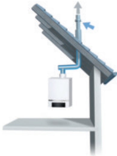
Raumluftunabhängige Aufstellvariante mit Rohr-in-Rohr-Kunststoff-Abgassystem
