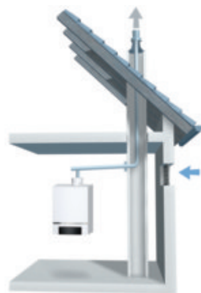
Raumluftabhängige Aufstellvariante mit eingezogenem Abgasrohr im Schornstein (Zuluft über Belüftungsöffnung)
